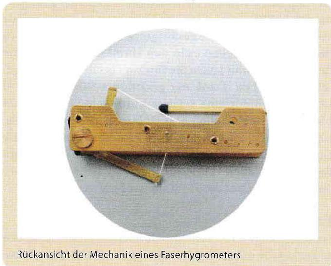
Rückansicht der Mechanik eines Faserhygrometers
